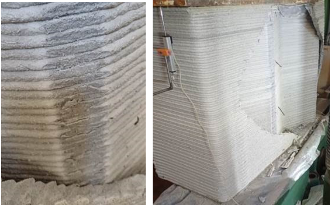
Obr. 3-4: Nedostatečné provázání při soutisku vrstev po zatěžovací zkoušce
