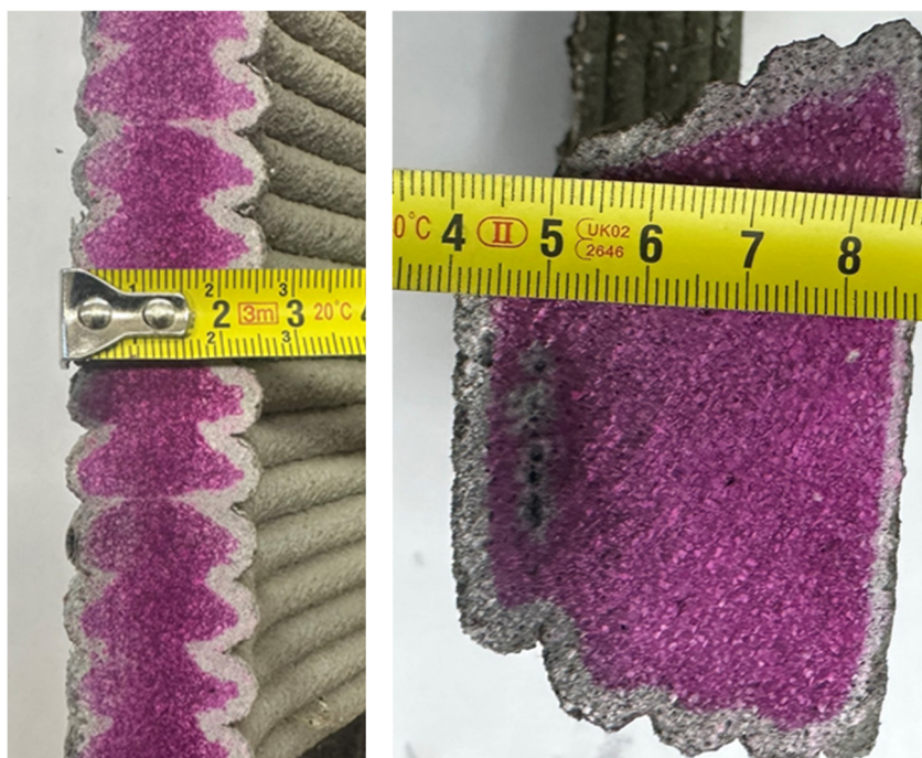
Obr. 2-21: Řezy vytištěného prvku a hloubku karbonatace.
